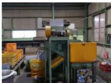
空き缶プレス機による圧縮
